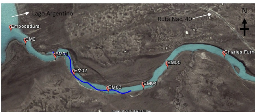
Secciones de medición de velocidad con ADCP
