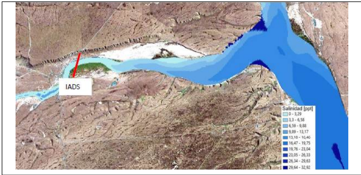
Figura 64: Salinidad en pleamar para escenario de QSC=550m^3/s y \Delta H=11,20 m (UNLP, 2017)
